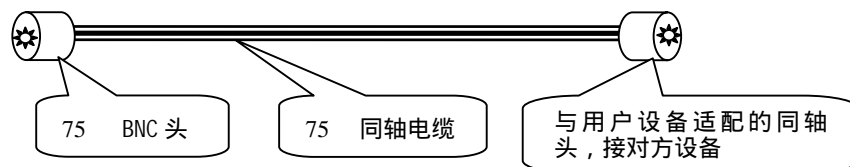
附图 3 75 BNC 接口连接的 E1 接口连线制作方法
