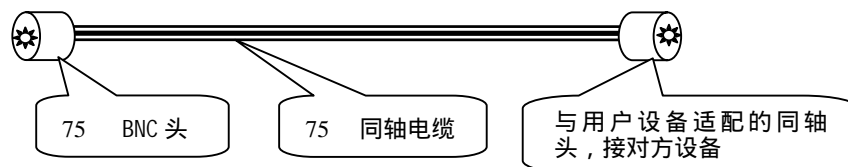
附图 3 75 BNC 接口连接的 E1 接口连线制作方法
